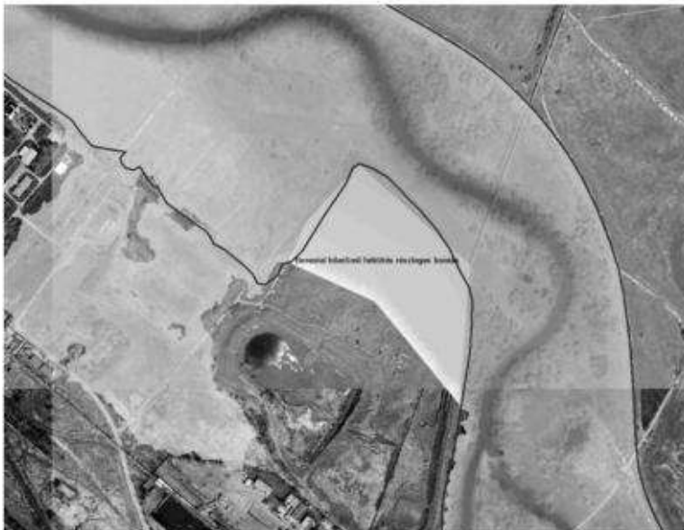
Berentei hőerőmű zagyter feltöltés részleges bontás, mely után a nagyvízi mederhatár módosulni fog
